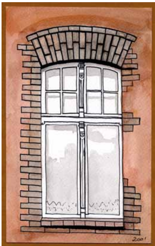
Rys. 1. Wieś Gieczyniek. Okno czterodzielne ze szprosami w górnych skrzydłach (rys. Kaja Cykalewicz)
